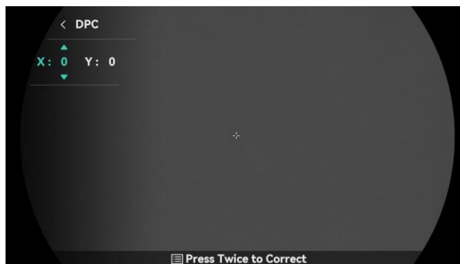
Figure 3-6 Correction de pixel défectueux
